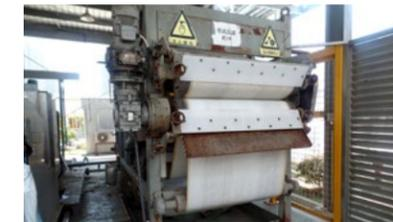
冰箱压缩机废水站老旧设备——带式压滤机
